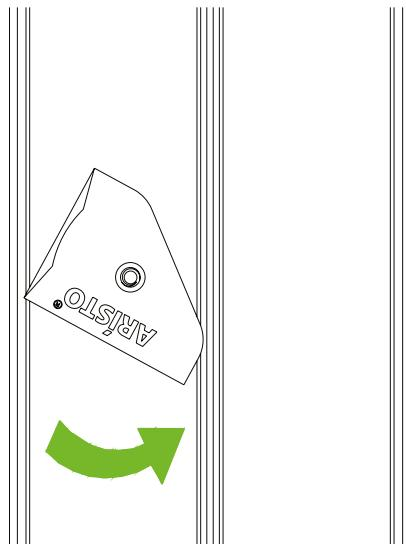
4 Фиксируем стопор с помощью шестигранного ключа.
