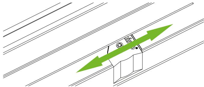
2 Разворачиваем стопор внутри направляющей.
